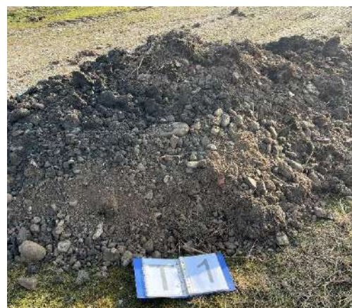
Foto n. 1: Cumulo 1 scavato da T.1
