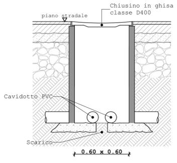
**SEZIONE TIPO CAVIDOTTI**
