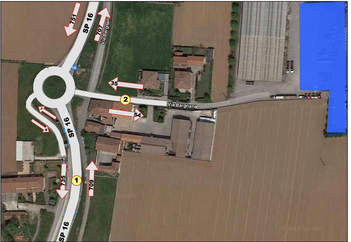
Flussi di traffico esistenti del venerdì (17:30/18:30)
