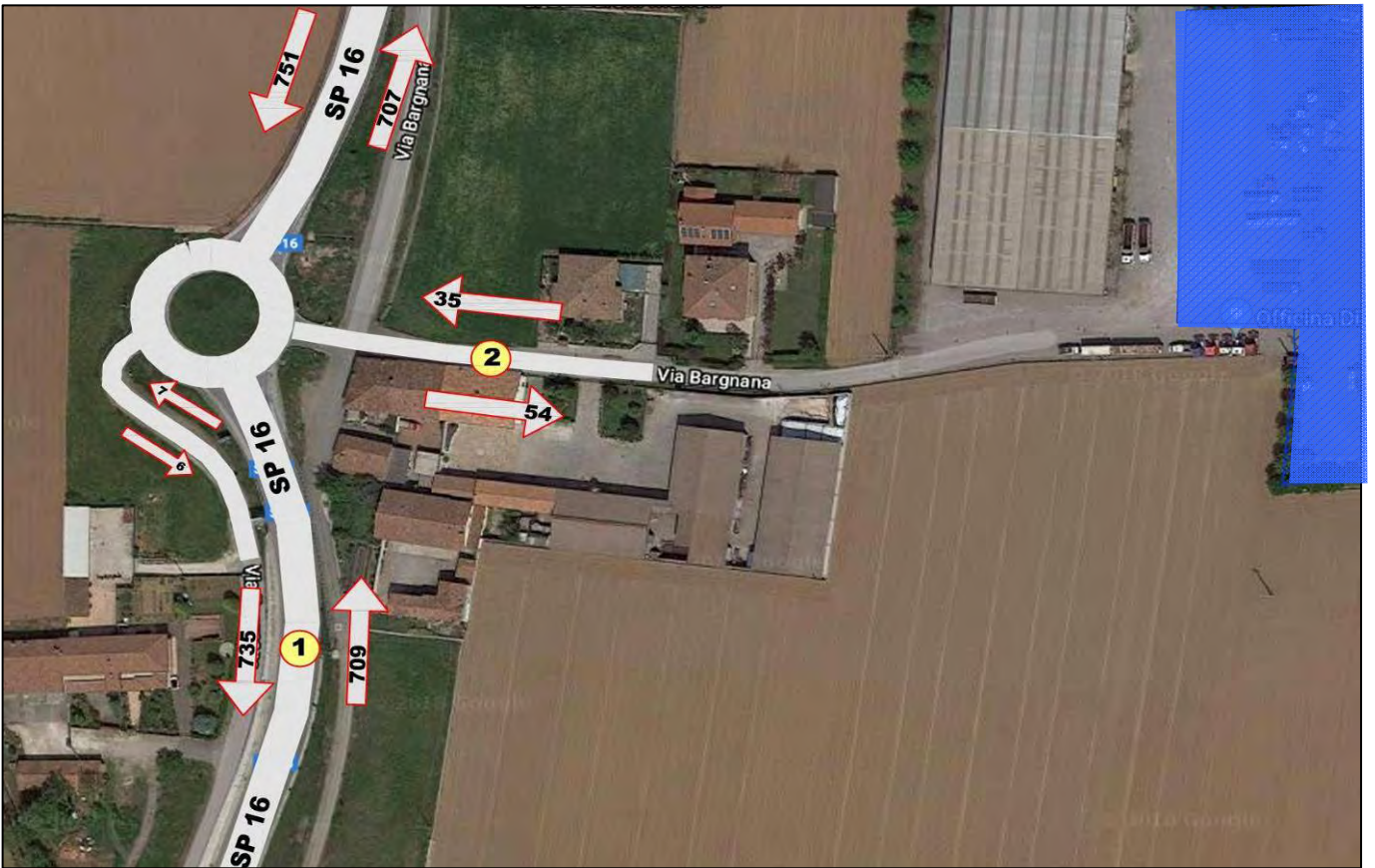
Flussi di traffico esistenti del venerdì (17:30/18:30)
