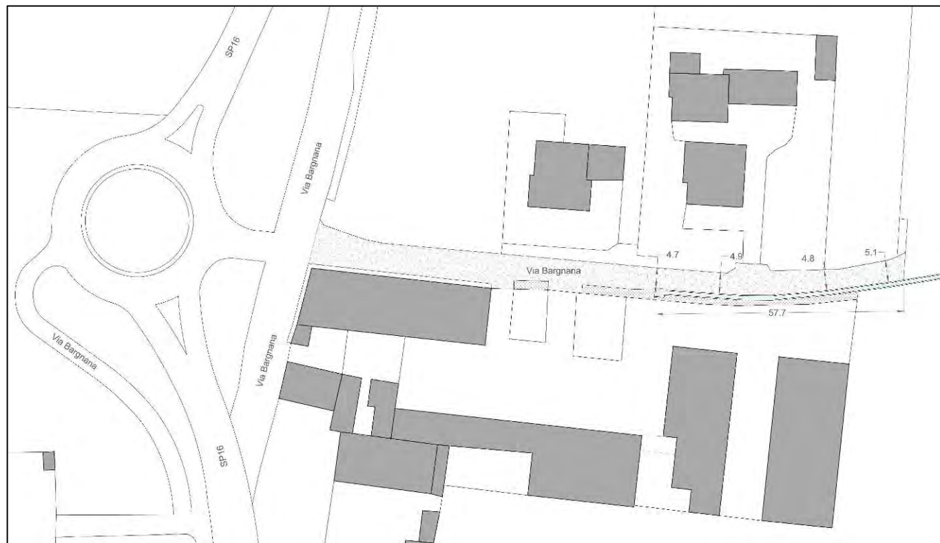
Estratto db topografico con inserimento del progetto della rotonda e della modifica della Via Bargnana con evidenziate le larghezze della carreggiata
